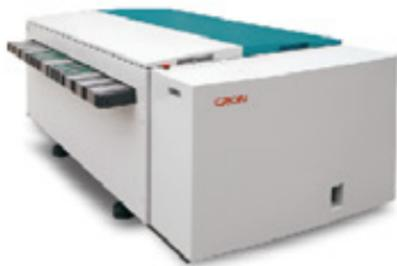
**model** TP 46\* **Laser Wavelength** 830nm
